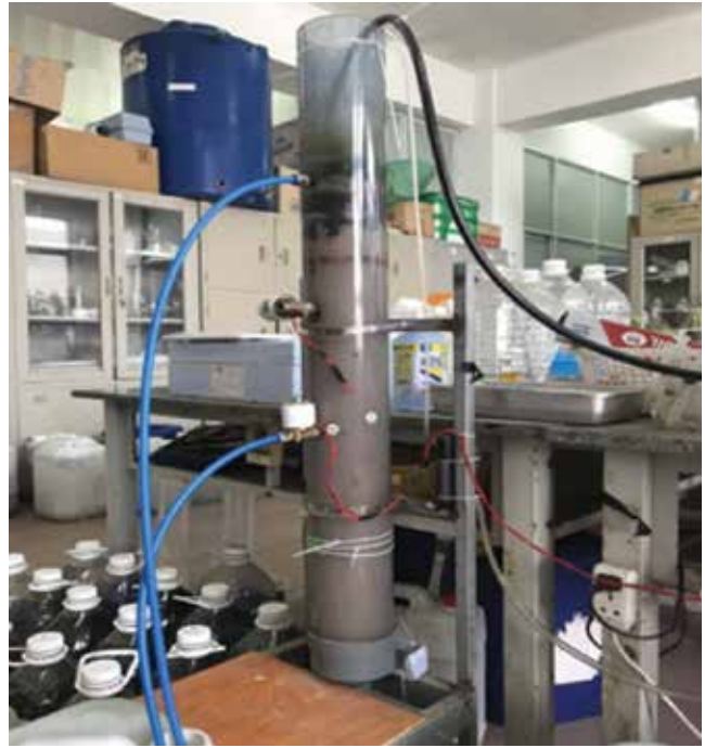
▲ Hình 2a. Mô hình bể SBR trong phòng thí nghiệm
